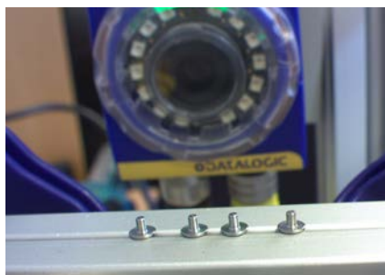
Även riktigt små detaljer går att inspektera. Kragen på detaljen är endast Ø4 mm.
